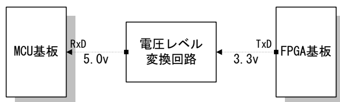
図 5 電圧レベル変換
